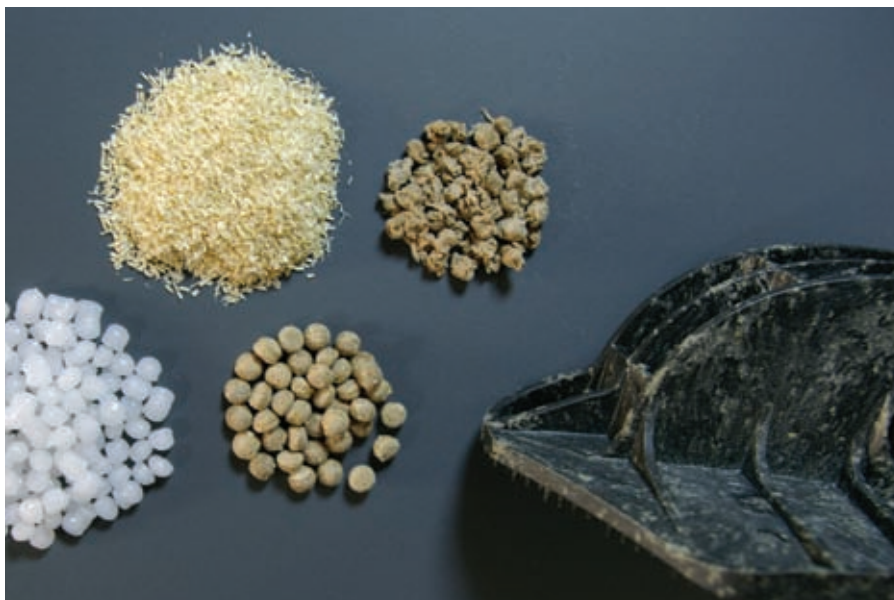
Aus Holzfasern oder -partikeln (oben), Standardkunststoffen (links) und weiteren Zusatzstoffen werden Granulat (Mitte) oder direkt Profile und Formteile (rechts) produziert.
