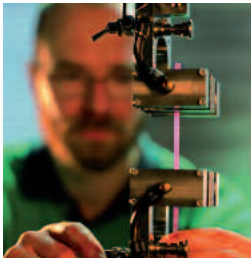
Ermittlung der mechani- schen Eigenschaften im Zugversuch
