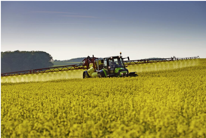
Abb. 4: Traktorhersteller setzen auf Pflanzenöl: Den Agrotion Natural Power liefert Deutz-Fahr serienmäßig mit Zweitank-Pflanzenölmotor aus. (Foto: Same Deutz-Fahr Deutschland GmbH)
