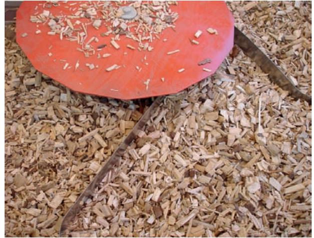
Abb. Federzinkenaustragung im Hackschnitzelsilo
