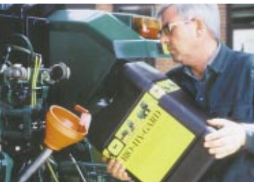
Biologisch schnell abbaubares Hydraulikbetriebsöl
